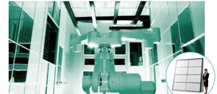
薄さ0.7mmの大型マザーガラスをロボットが搬送する液晶工場
