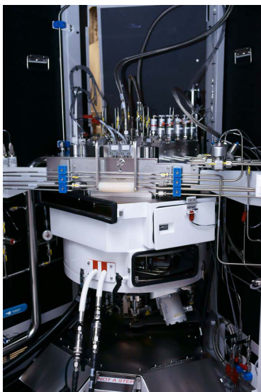
図 3.5-11 8インチ MOVPE 装置 [2]
