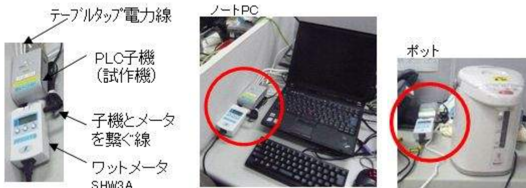
図 4.1-3 PLCによる電力計測*35
