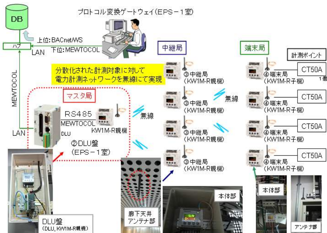
図 4.1-5 無線通信 (ZigBee) による電力計測*37
