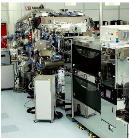
図 3.5-8 EUV 露光装置 (左) とロジックとメモリの積層 (右) [2]
