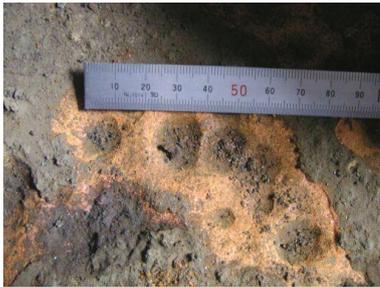
図4.9.1 実際の孔食(配管内面より撮影)
