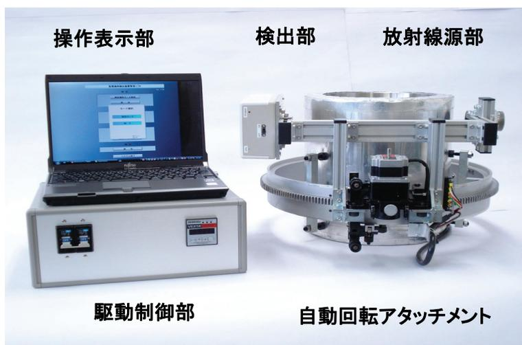
図 4.8.1 配管厚さ測定装置のシステム構成
