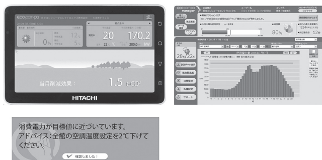
図-2 表示端末 (左上), アドバイスの例 (左下), 本社での管理画面例 (右)
