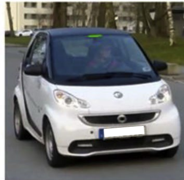
(c) ウィンドスクリーン部での ストリップライト表示
