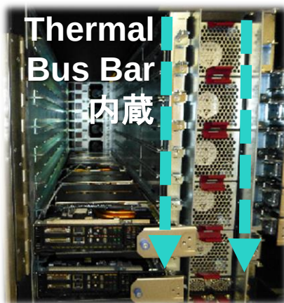
Thermal Bus Bar 内部 のみ、冷却水が循環
