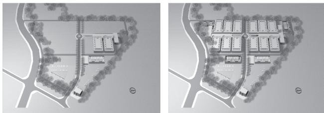
図1：モジュール構造による増築イメージ
