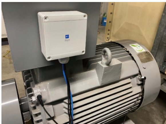
図 4.8.2.2 振動センサーと送信器(LAN 伝送式) 外観
