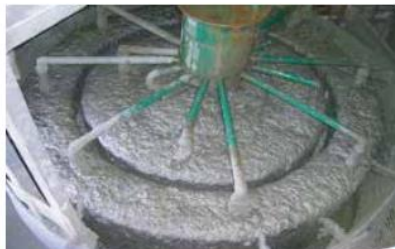
選鉱場では粒径10~50cmあった鉱石が、粒径数10μm程度まで細かくされ、有用鉱物が分離・回収されます。
