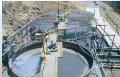
選鉱工程で分離された非有用鉱物（尾鉱）はシクナーを経てたい積場へ送られます。
