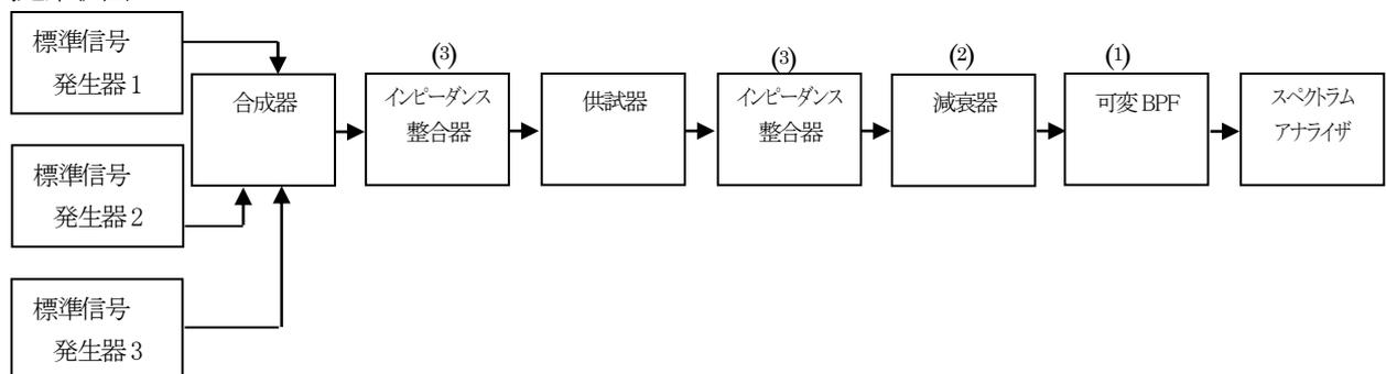
注(1) 測定信号とひずみのレベルの差が大きい場合、スペクトラムアナライザが飽和するのを防ぐため、測定信号を減衰させ、ひずみ成分を通過させるバンドパスフィルタ(又はノッチフィルタ)を設ける。
