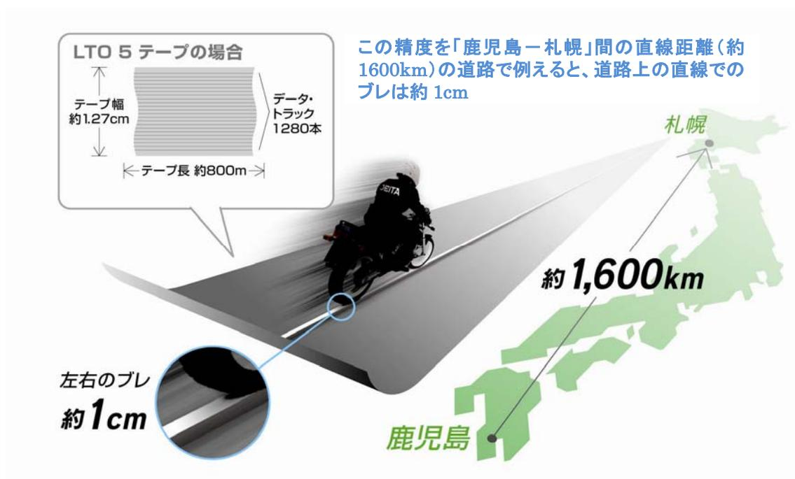
秒速 16 キロメートル、左右のブレ幅 1 センチメートルで、鹿児島ー札幌間 1600 キロメートルをバイクが一直線に疾走している姿を想像してみてください。ロケットの打ち上げ速度よりも速く走るバイクはありえないが、速度・距離に対するブレ幅の小ささから、高精度でテープとヘッドの位置の関係が保たれている（サーボされている）のが分かるはずである。
