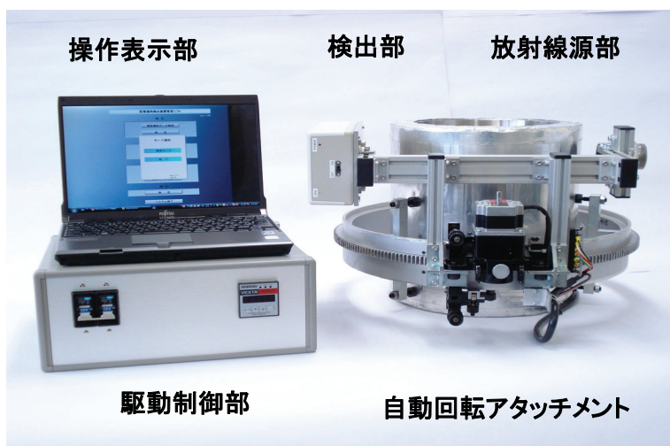
図 4.8.1 配管厚さ測定装置のシステム構成
