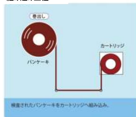
組み込み工程
