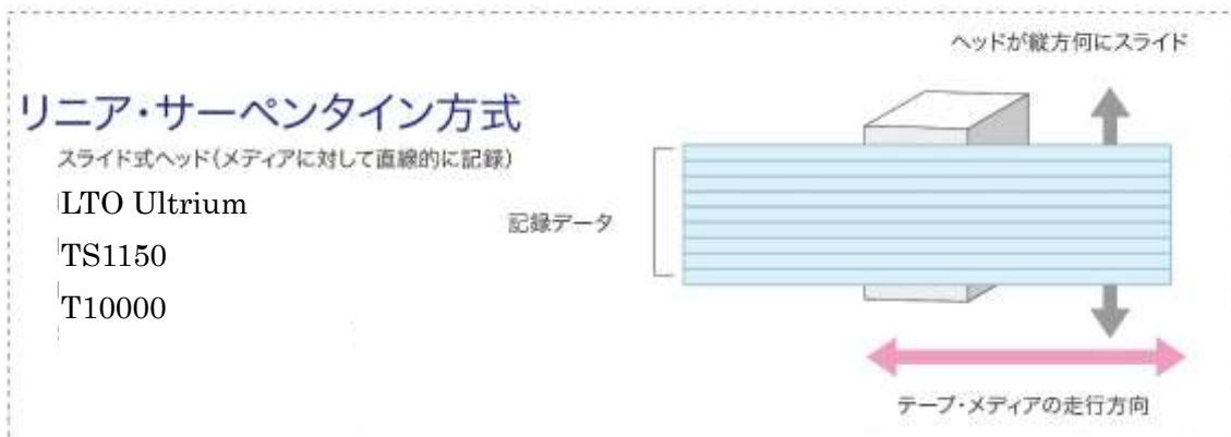
図 2. リニア・サーペンタイン方式の仕組み
