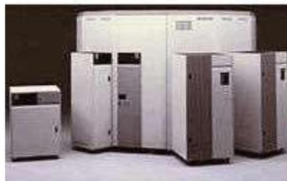
写真左はオートローダーを備えた IBM 3480 磁気テープサブシステム。今から 34 年前の 1984 年 3 月に発表された。一台のコントローラーに合計 8 台までのテープドライブを接続することができ、それぞれのドライブにつき 6 巻のカートリッジを自動でロード／アンロードすることができた。
