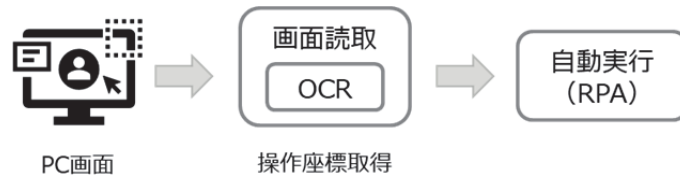
図 2.2-2 UI 操作自動化のための OCR 利用
