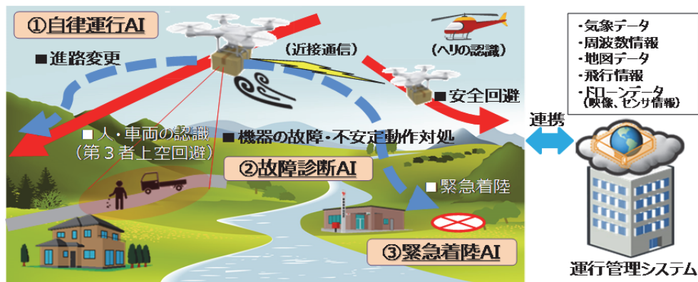
図 3.3-3 「落ちない落ちて安全」なドローンのための AI 技術
