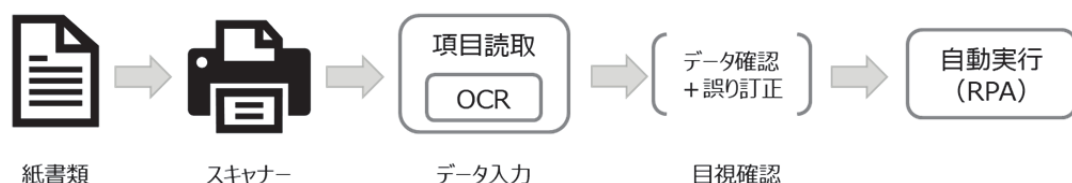
図 2.2-1 RPA 向けデータ入力自動化のための OCR 利用
